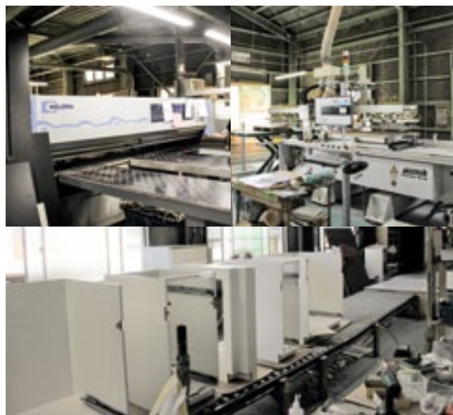
部品の切出し、穴あけ加工は機械で自動化 オーダー製品は組立後出荷をしている
